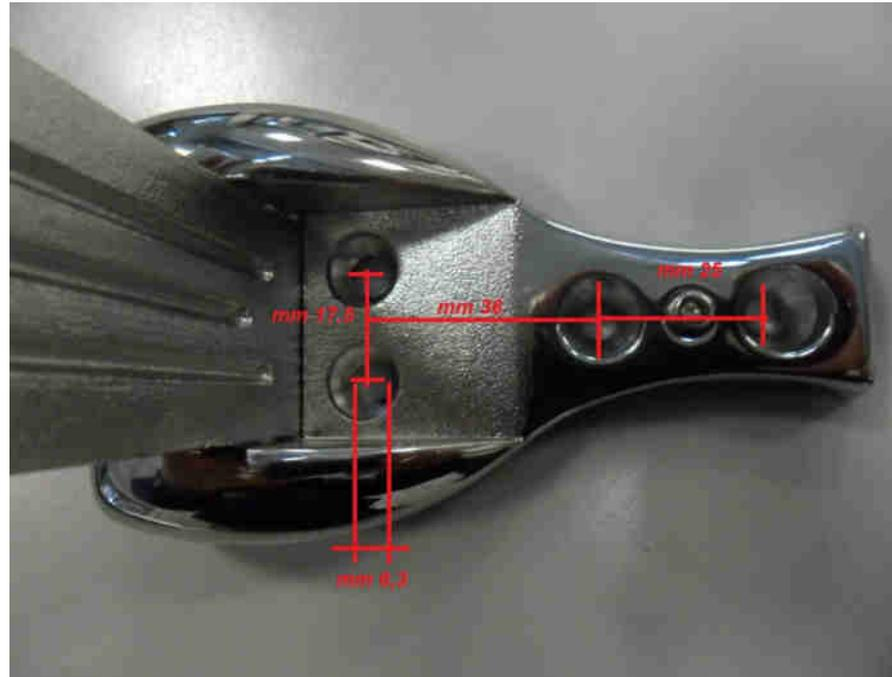
Klappbare Maststufe - ideal für Alu-Masten. - EPDM-Korrosionsschutz-Dichtung; - Vibrationsschutz mit einstellbarem Nylon-Gewindestift; - breite, rutschfeste Stufe; - aus hochglanzpoliertem Edelstahl AISI 316. Montage mit M6-Schrauben.
